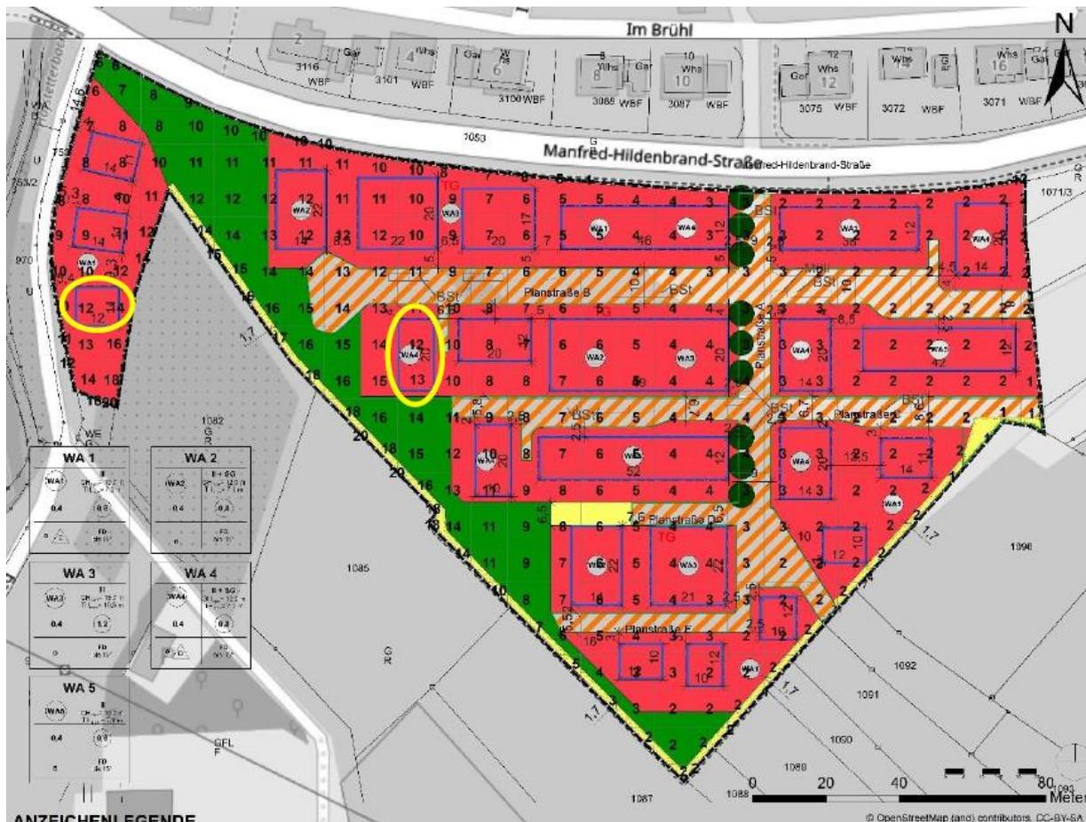
Abb. 22: in Gelb: Baufelder an der Grenze zu Bereichen mit  $\geq 15\%$  Jahresgeruchsstundenhäufigkeit (Quelle: Geruchsgutachten)
