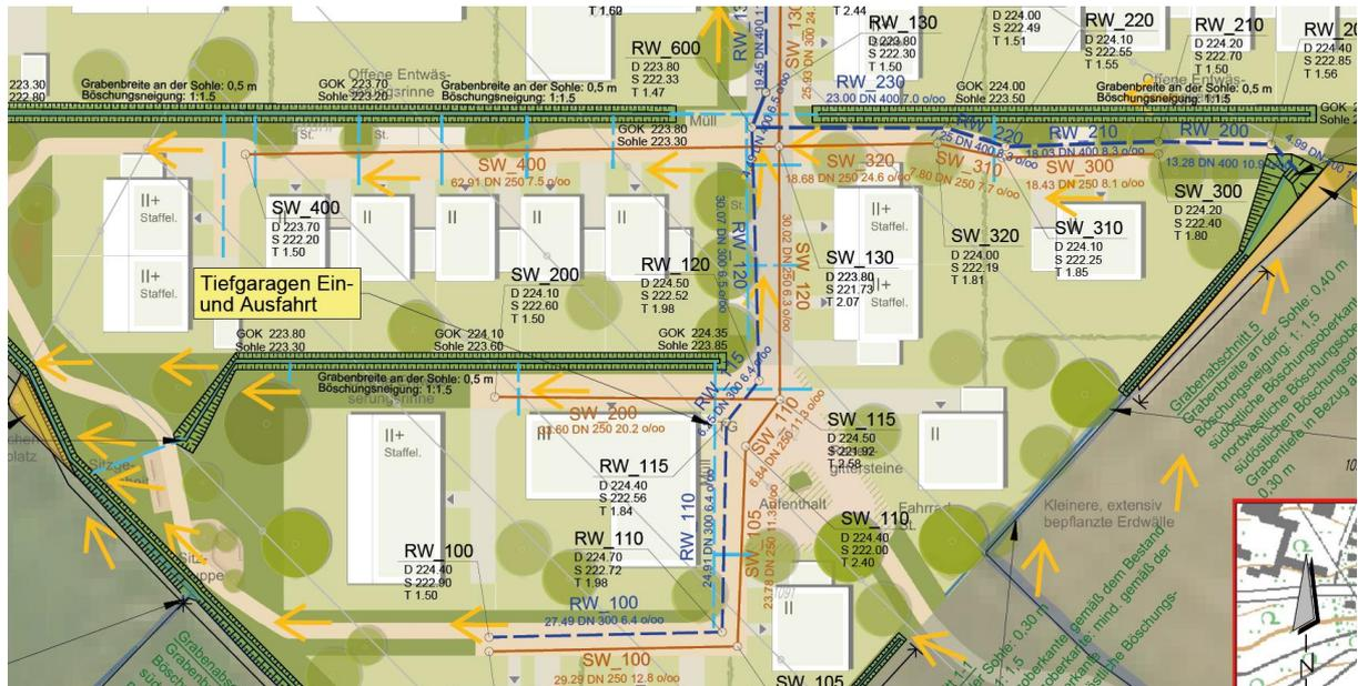
Abb. 18: Anschluss an das Entwässerungsgrabensystem (helblau; Auszug Anlage 2-1 Lageplan)
