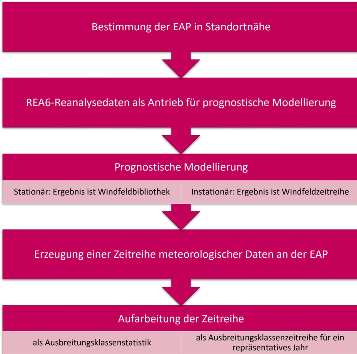
**Abbildung 7: Sequenzieller Ablauf bei der Erzeugung modellierter Daten**
